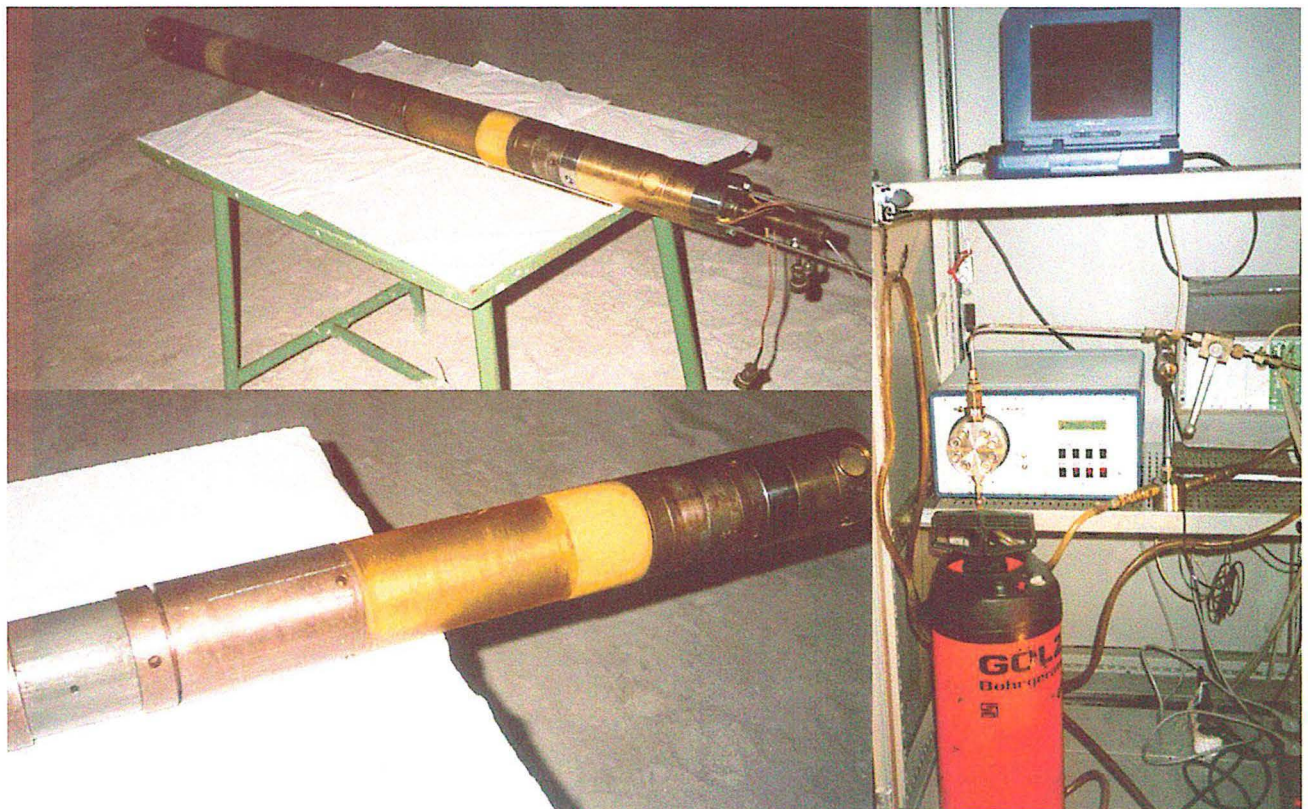
Abbildung 7: Equipment für Spannungssondierungen in Bohrlöchern mit Durchmessern von etwa 101 mm
